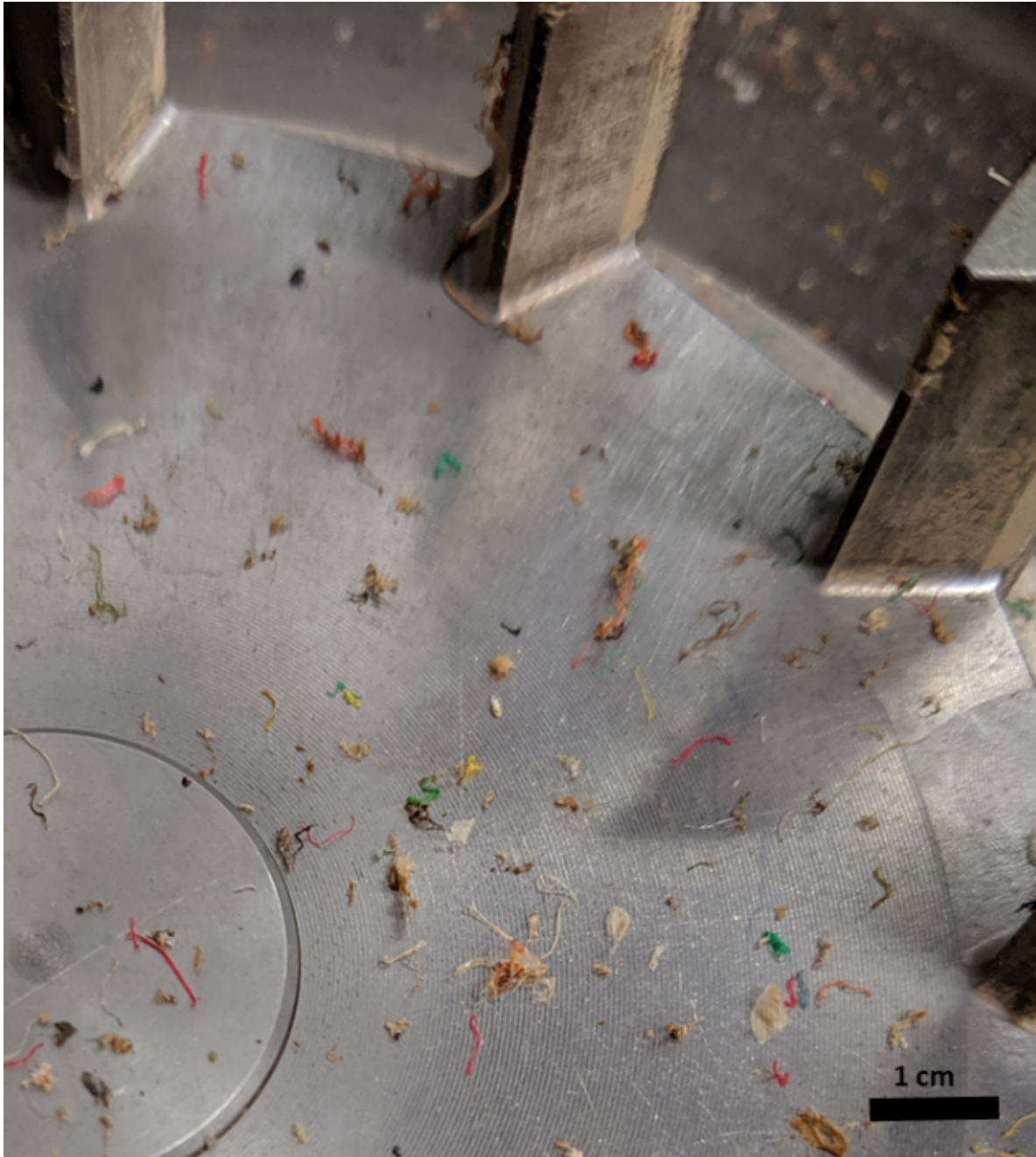
Abbildung 15: Foto der Mahlkabine inklusive Mahlrückstand, der von den Messern der Ultrazentrifugalmühle nicht erfasst werden konnte © TU Wien
