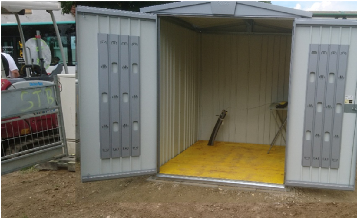
Abbildung 52: Metallische Messhütte der Niederschlagswasserkanal-Messstelle Graz – Ziegelstraße © TU Graz
