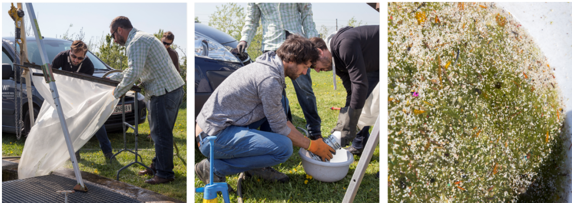
Abbildung 13: linkes Bild – Säubern des Messnetzes in der ARA 2; mittleres Bild – Entleeren des Sammelbehälters, rechtes Bild – generierte Probe im Probenkübel © Umweltbundesamt/Hohenblum
